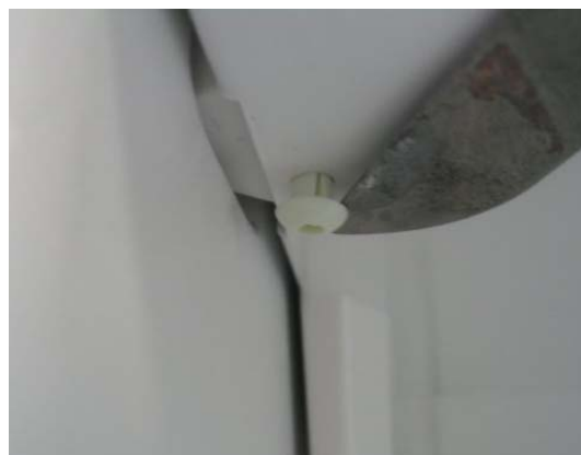
Fig. 7.2.1/ 3 Remove plastic rivets
