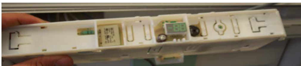
Fig. 7.1/ 6 Disengage electronic module
